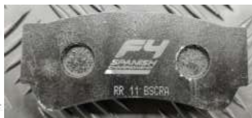
Lado del pistón de la pastilla / Piston side of the pad
